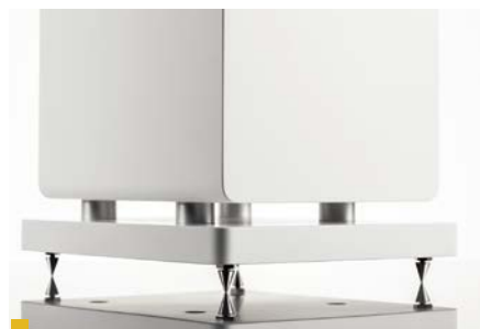
Przerwa pomiędzy cokołem a dolną ścianką jest konieczna - w spodzie znajduje się ujście podwójnego portu BR.
