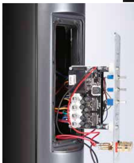
Die Aktivmodule der SR 3 sitzen direkt am Terminal-Einschub. Treble- und Bassschalter (rechts) erlauben eine feine Klangabstimmung.
